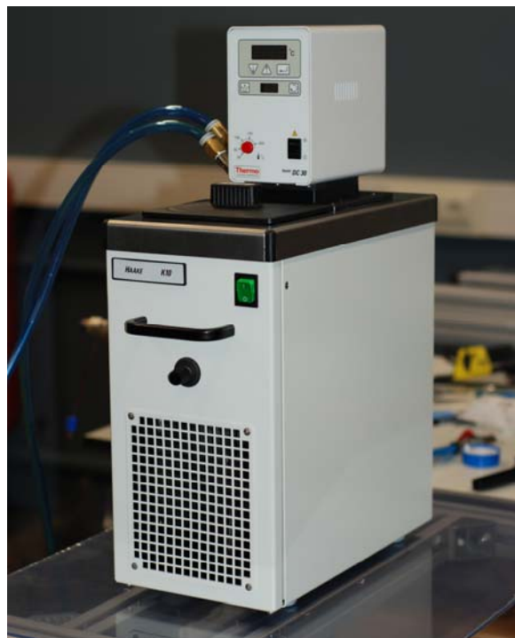
Figura 7. Baño termostático Haake DC30-K10.
