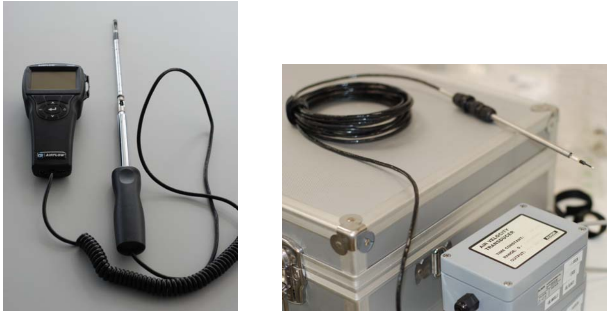
Figura 6. Anemómetro de hilo caliente manual (izquierda) y Transductor de velocidad (derecha).
